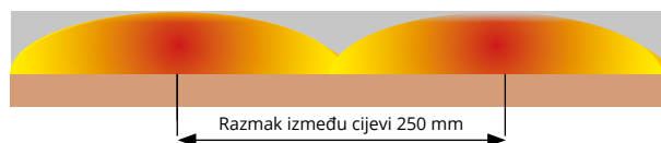
Suho polaganje s aluminijskim limom koji provodi toplinu
