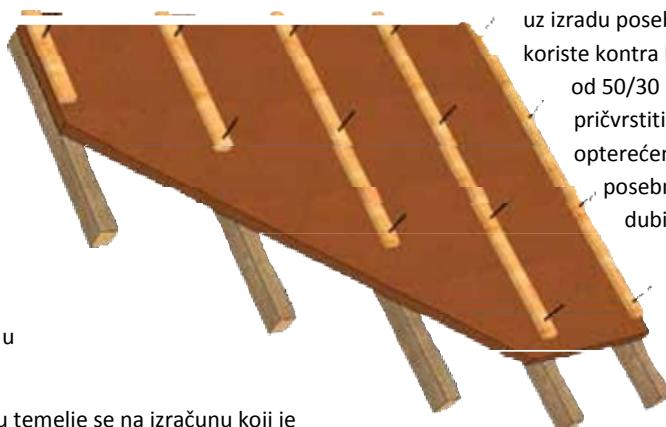
Ostala povezna sredstva mogu se koristiti uz izradu posebnog izračuna. Ako se koriste kontra letve poprečnog presjeka od 50/30 mm, potrebno je pričvrstiti nosive letve opterećene usisom vjetra posebnim čavlima (najmanja dubina umetanja 8-strukog promjera glatkih čavla ne postiže se s 30 mm).
